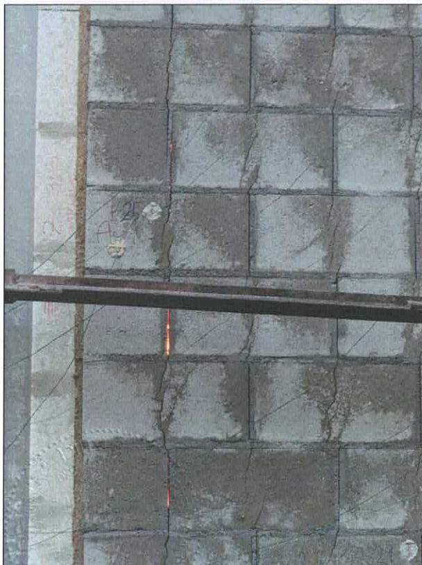
NS, svislé trhliny na bocích stěny – 121. minuta
